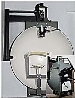
Coupole de Goldman (vue des côtés patient et praticien) Au dos de la coupole, un levier solidaire d'un pantographe permet de déplacer manuellement l'index lumineux.
