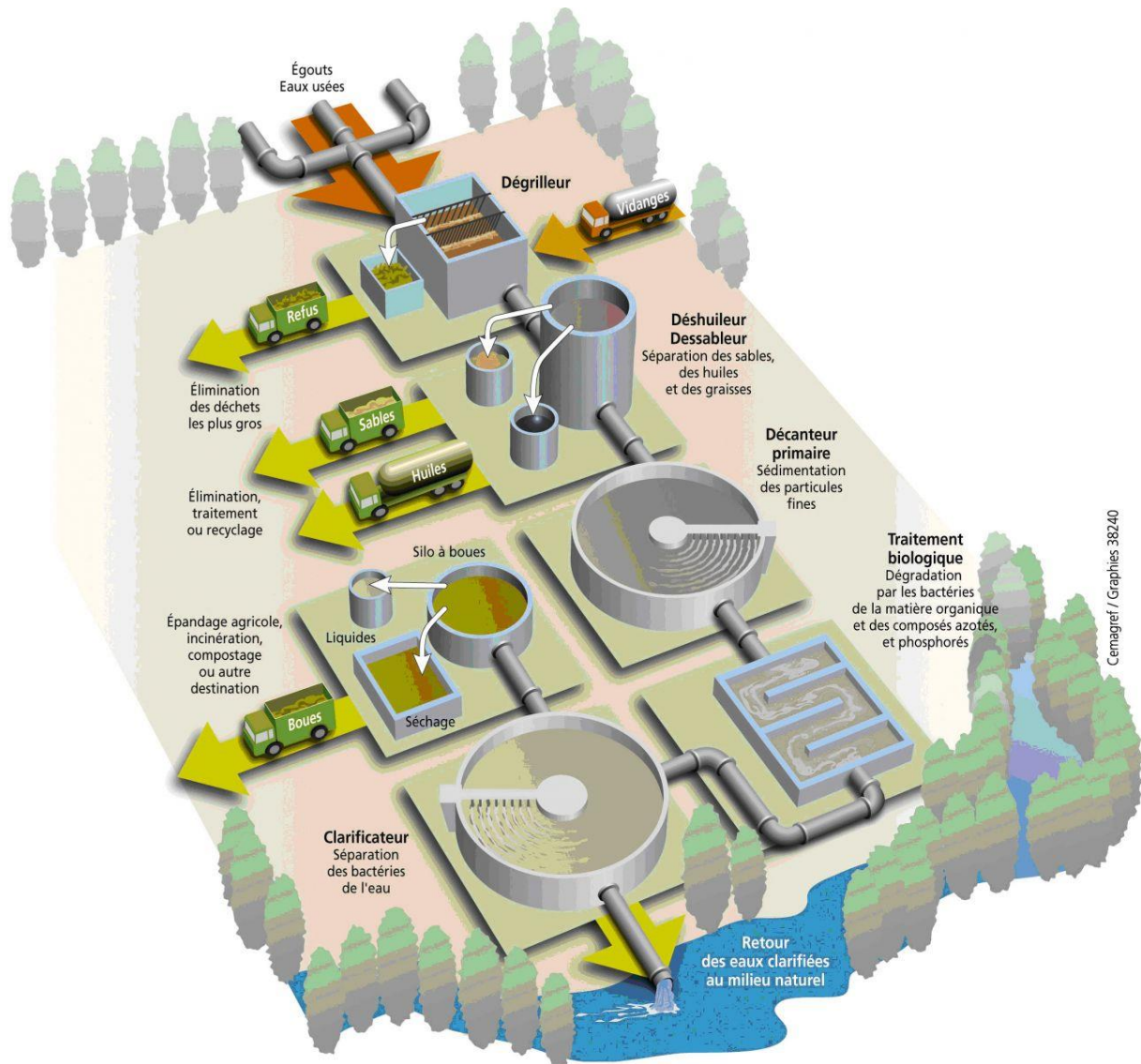
Figure 2. Le fonctionnement d'une station d'épuration (IRSTEA).
