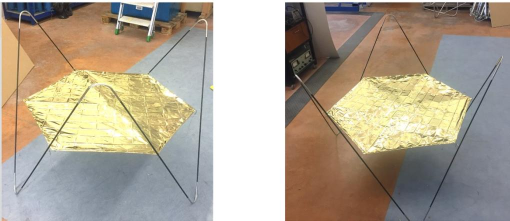
Figure II-29 : Prototype de voile à ouverture partielle
