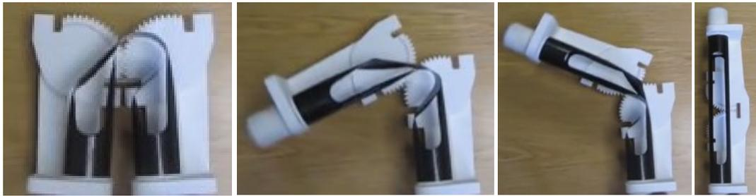
Figure IV-86 : Liaison flexible autobloquante en position ouverte et alignée (Oxford)
