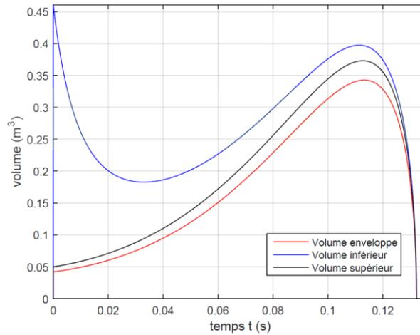
*Figure X-1 : Evolution du volume d'un tétraèdre libre en fonction du temps*
