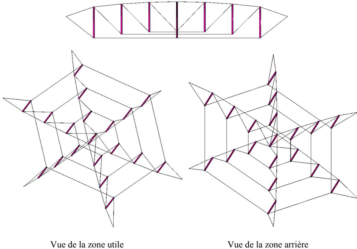
*Figure IV-45 : Réseau radial de type Geiger*
