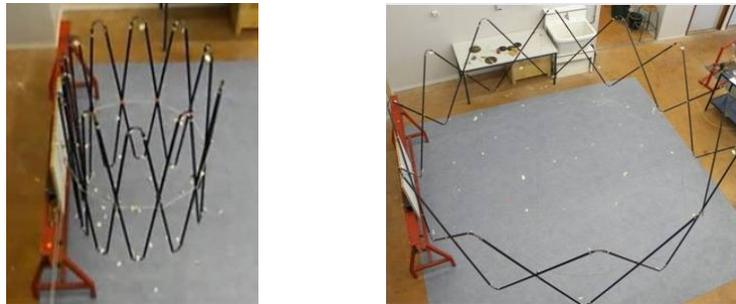
Figure I-28 : Démonstrateur développé au LMGC composé de lames de carbone comme liaisons souples (Mortierolle-1, et al., 2015)
