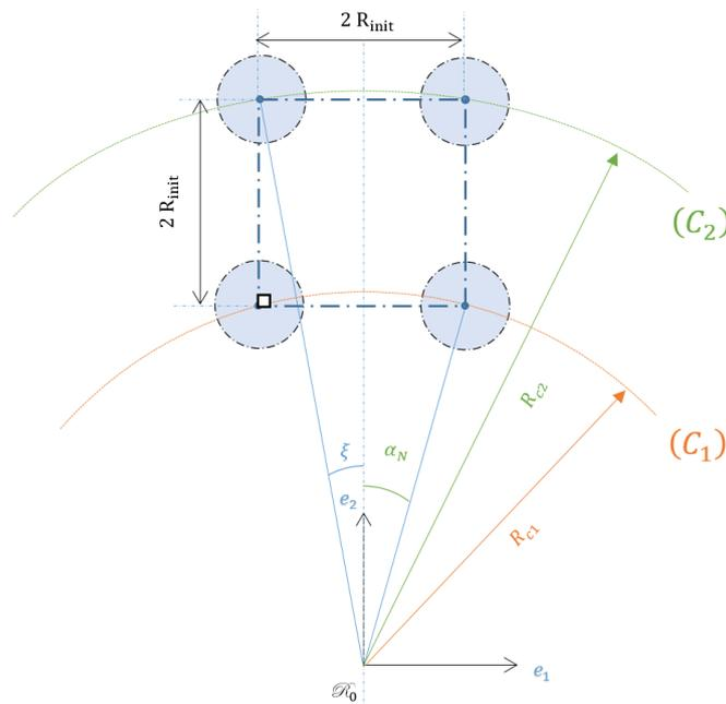
Figure II-17 : Géométrie d'une portion de structure « 2-cercles »
