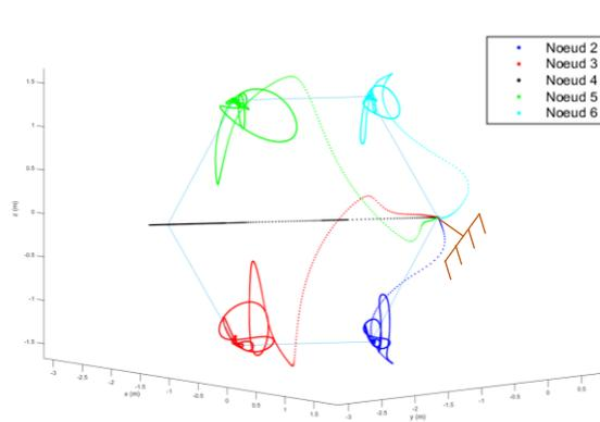
Figure III-34 : Déplacements des nœuds centraux des barres pour un système à 6 barres arrimé.
