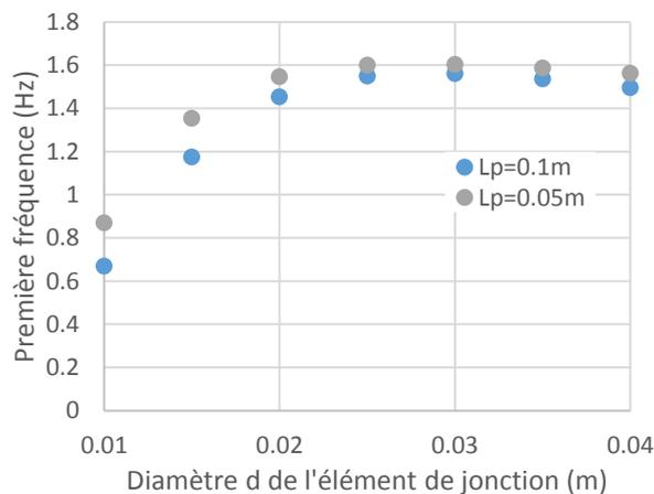
Figure IV-64 : Rigidité de l'anneau en fonction du diamètre des éléments de jonction
