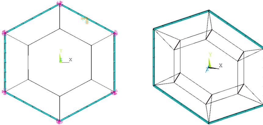
Figure IV-35 : Réseau tridimensionnel composé d'une seule couronne
