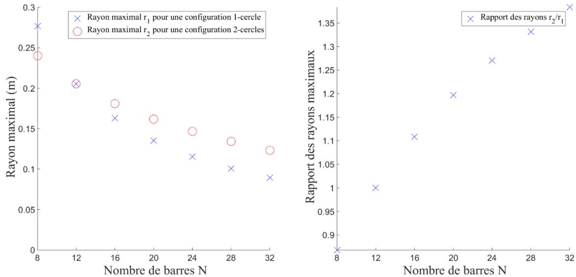
Figure II-19 : Comparaison entre les rayons maximaux des barres pour les 2 configurations avec  $R_{circum2} = 1 m$
