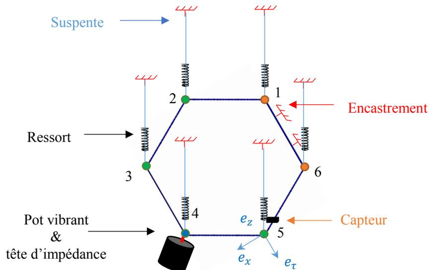
Figure IV-71 : Schéma du dispositif expérimental
