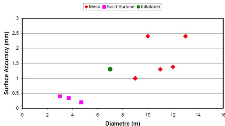
Figure I-4 : Précision de surface en fonction des différents diamètres d'ouverture pour différentes catégories de réflecteurs (Mangenot, 2010)
