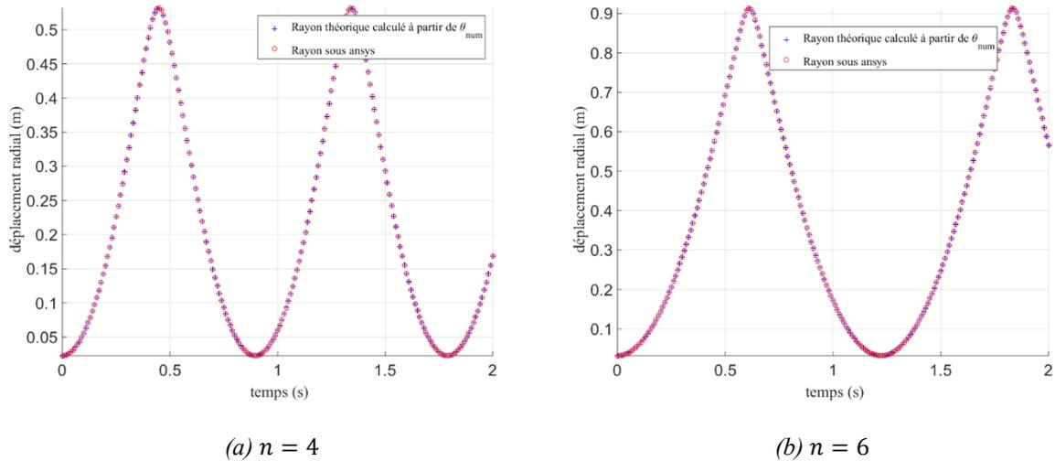
Figure III-23 : Représentation des deux rayons  $R_s$ , le premier géométrique et le second calculé à partir de  $\theta$  numérique
