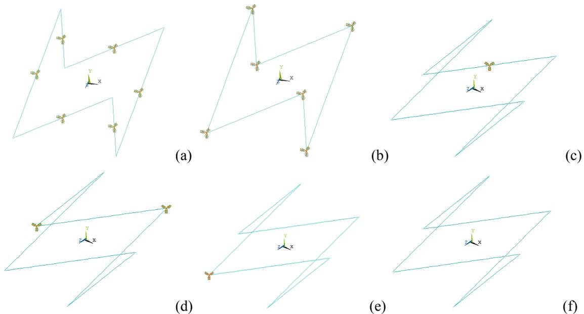
Figure IV-5 : Différentes configurations de fixation de l'ossature.
