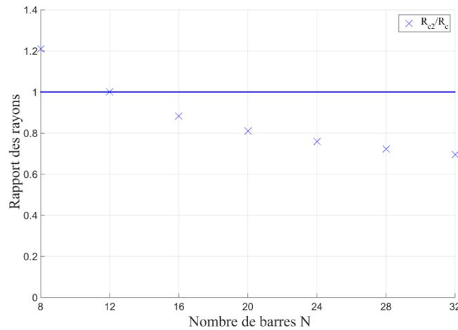
Figure II-18 : Rayons pour les configurations « 1-cercle » et « 2-cercles » en fonction de  $N$ .
