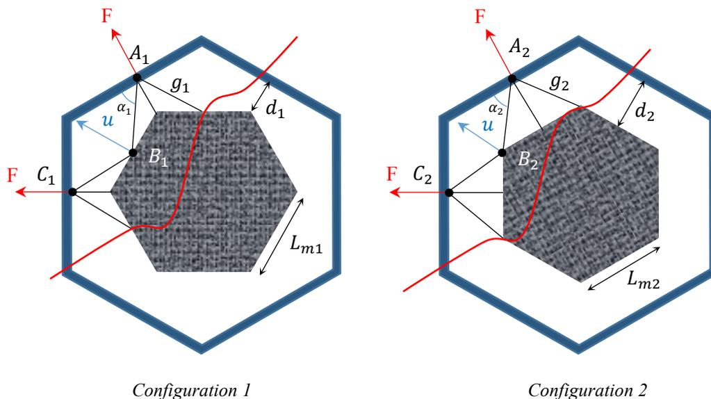
Figure IV-87 : Différentes configurations de positionnement de la membrane dans l'anneau
