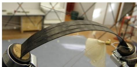
Figure I-29 : Délaminage de lame (Mortierolle-2, 2011)
