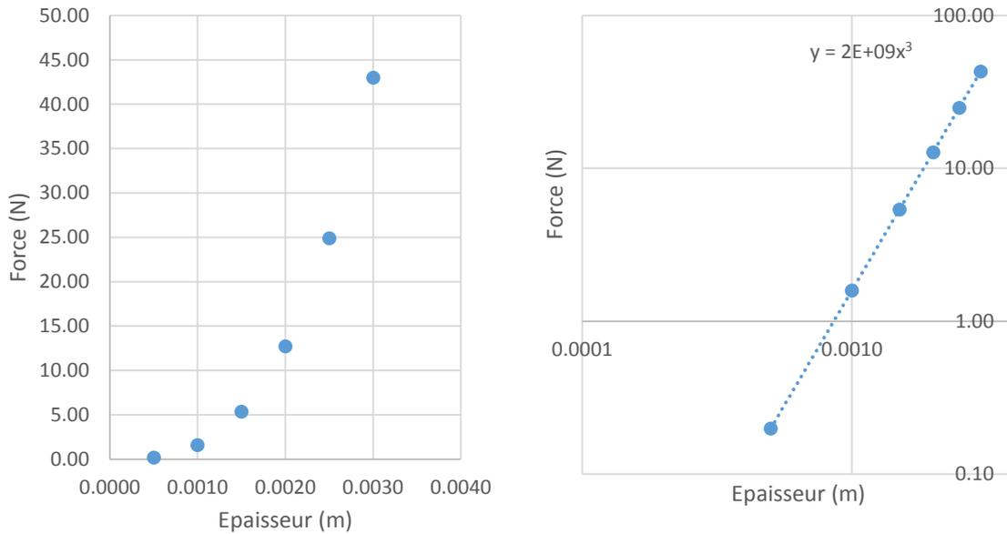
Figure IV-57 : Représentation graphique de la tension du câble en fonction de l'épaisseur de la lame
