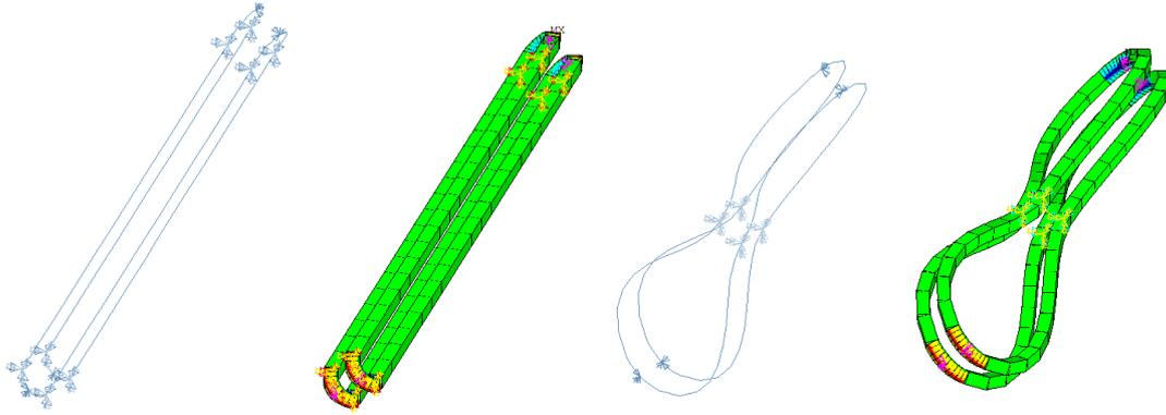
Figure III-18 : Solutions de mise en précontrainte et effets sur les contraintes internes (relevées par la déformée) en configuration gerbée
