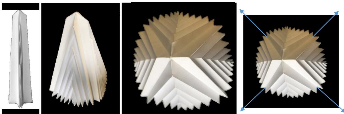
Figure IV-90 : Un mode de pliage de la membrane
