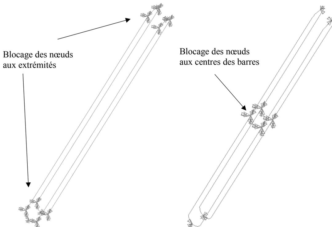
Figure III-17 : Différentes options de fixation de la structure en configuration gerbée
