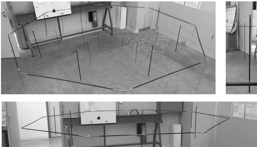
Figure IV-41: Anneau octogonal et réseau de type Geiger
