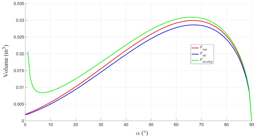
Figure II-10 : Représentation des 3 approximations du volume du tétraèdre
