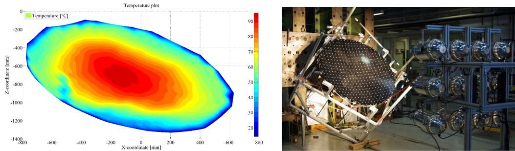
Figure IV-88 : Thermo-déformation de la surface CFRS (Datashvili-3, 2014)
