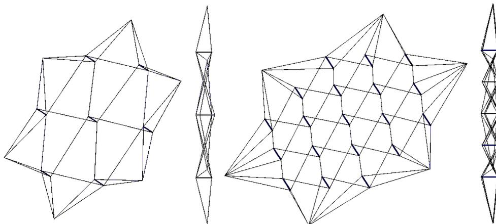
Figure IV-53 : Réseau isostatique composé de 7 et 19 barres
