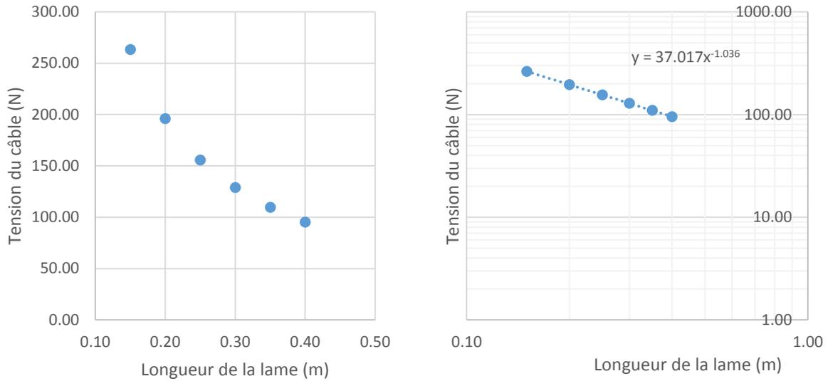
Figure IV-59 : Représentation graphique de la tension du câble en fonction de la longueur de la lame
