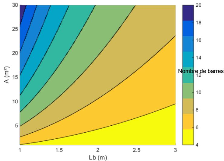
Figure II-12 : Nombre de barres nécessaires en fonction de leur longueur et de la superficie minimale désirée
