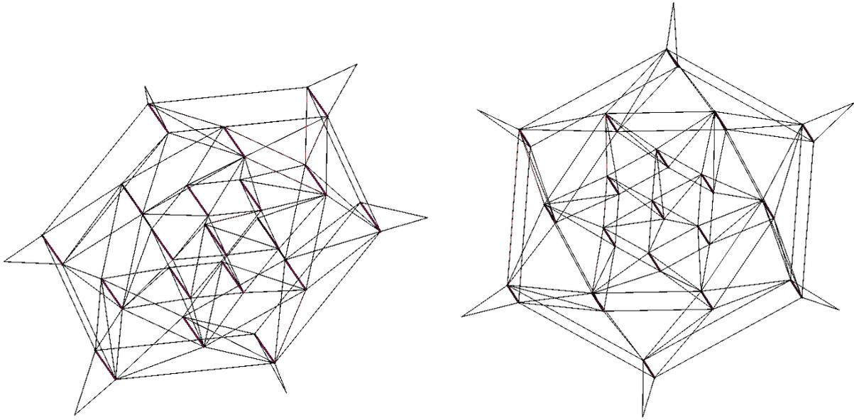
Figure IV-48 : Réseau diamatique de type Fuller contreventé
