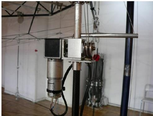
Figure I-21 : Système de motorisation du déploiement (Medzmariashvili-2, et al., 2014)
