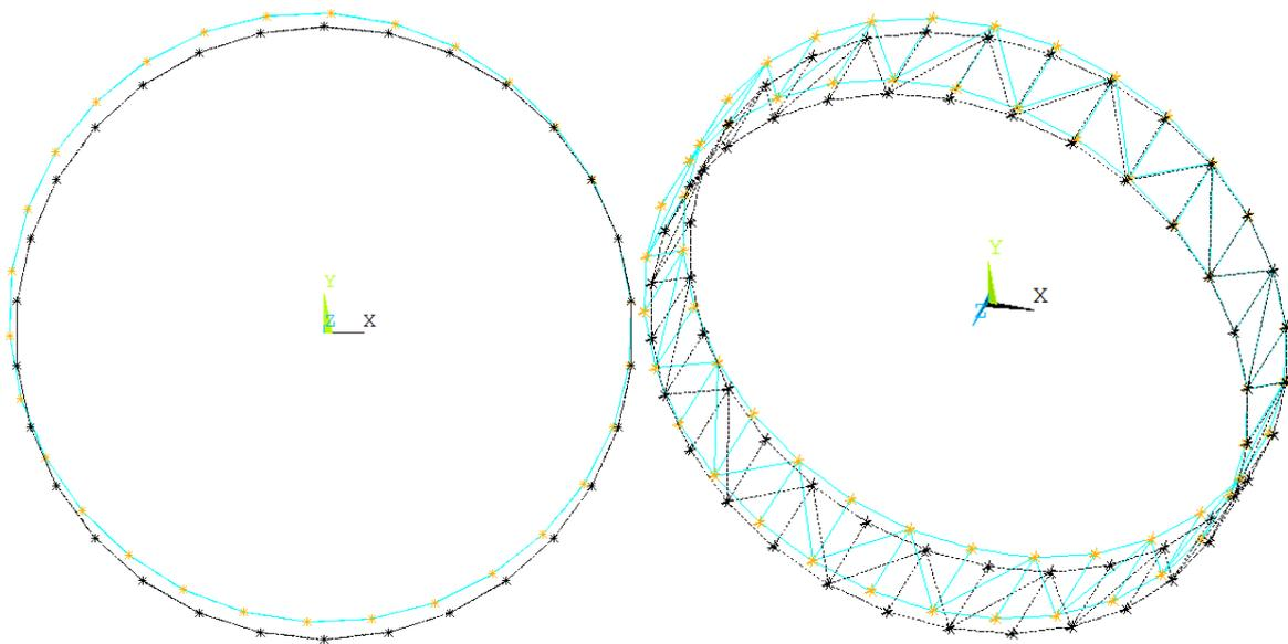
Figure IV-1 : Ossature de type Astromesh - 1<sup>er</sup> mode de vibration
