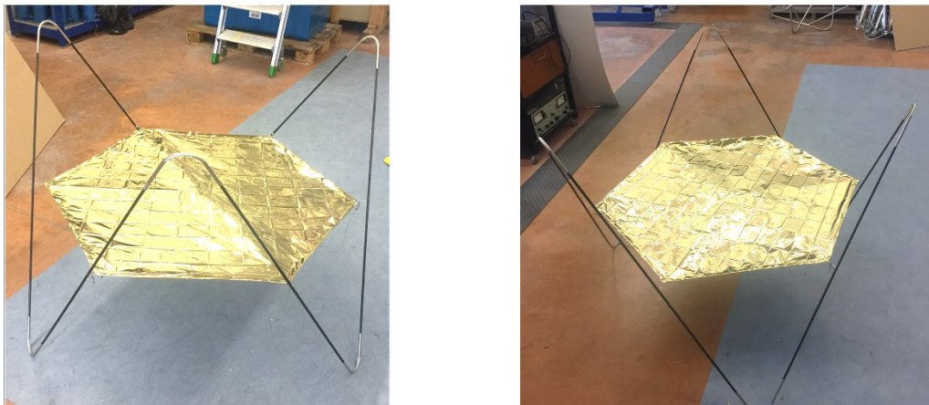
Figure II-29 : Prototype de voile à ouverture partielle
