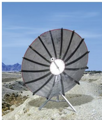
Figure I-10 : Antenne déployable de 1,2 m de diamètre (HPS)
