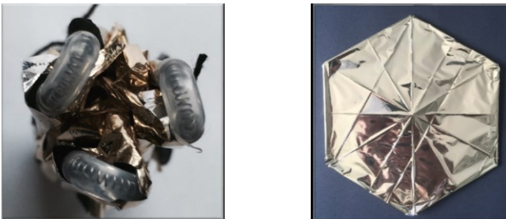
Figure II-31 : Photos du démonstrateur d'une voile, en fagot et déployé
