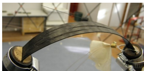
Figure I-29 : Délaminage de lame (Mortierolle-2, 2011)
