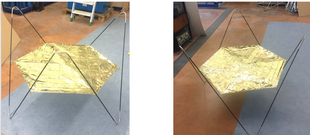
Figure II-29 : Prototype de voile à ouverture partielle
