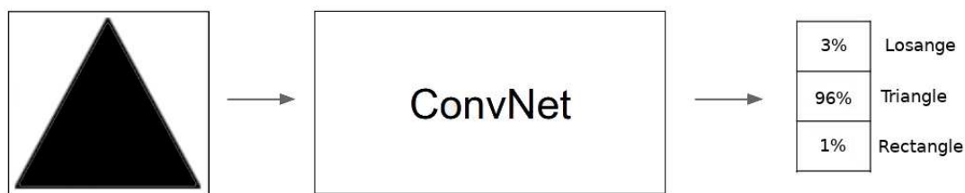
FIGURE 5.6 – Système classant des losanges, triangles et rectangles. Le plus haut score est obtenu pour la forme triangle. La prédiction du réseau est correcte.
