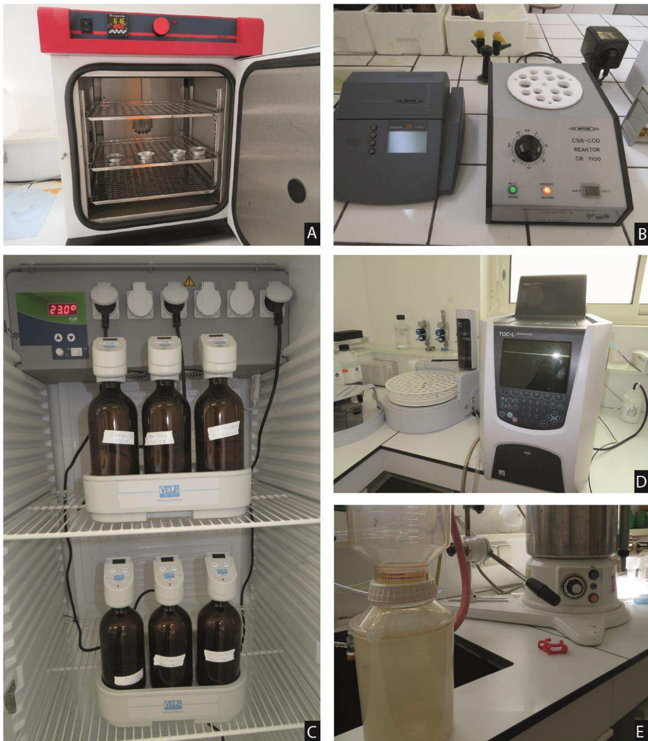
Figure 2-11: A : étuve B : bloc chauffant WTW CR 1100 et Photomètre pour microméthode WTW Photolab S6 C : BOVELP Scientifica. D : E D.TOC VCSN Shimadzu E : équipement de filtration sous vide.
