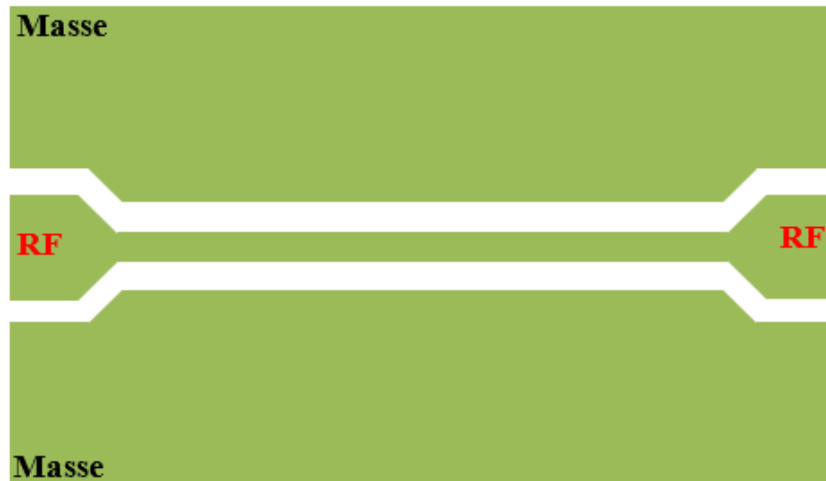
Figure II-15 : Structures d'une ligne coplanaire.
