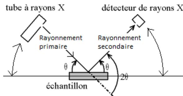
**Figure 16 : Chambre de rayons X (Serna et al., 2014)**
