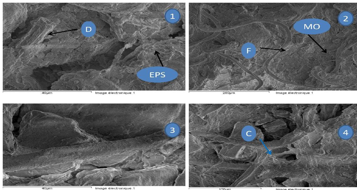
**Figure 29 : Micrographies au cryo-microscope électronique à balayage à émission de champ de la surface de la croûte microbienne de Sampieri sur parcelle Témoin naturel (1-4 X 1300/250/1300/450). F: filaments; MO: matière organique D: diatomées ; EPS : permettent de fixer les grains les plus grossiers, C: cavités formées par l'agencement des grains et le recouvrement de matière organique.**
