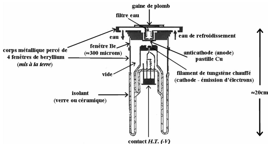
Figure 15 : Schéma du tube (Serna et al., 2014)
