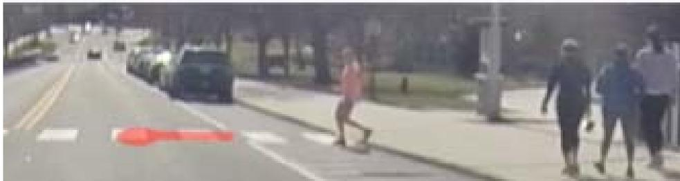
Figure 16: Ombre virtuelle du piéton identifié comme étant sur le chemin du véhicule-sujet (Kim et al., 2016)
