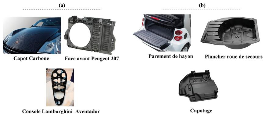
FIGURE 1.4 – Pièces pour l'automobile en matériaux composites : (a) thermoplastiques et (b) thermodurcissables [Celle 15]
