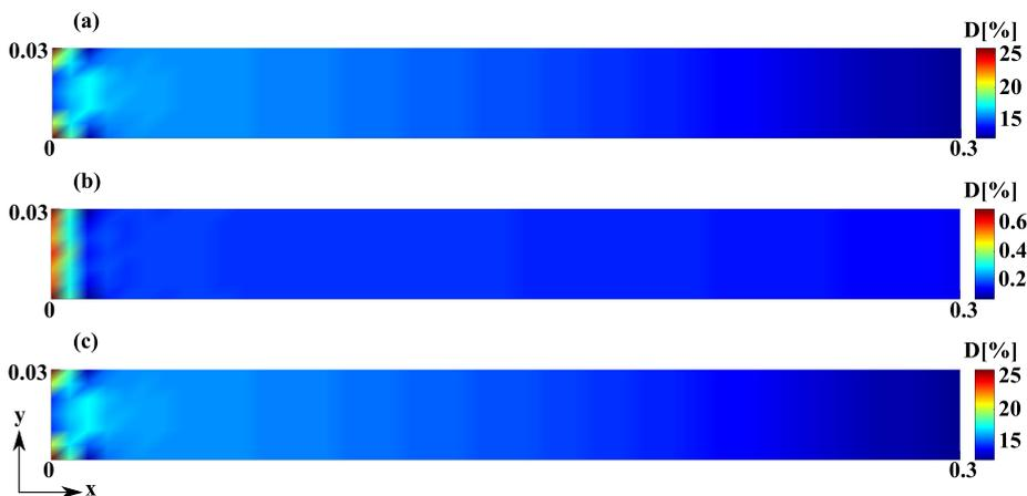
FIGURE 3.13 – État de l'endommagement par couche de la poutre  $(90^\circ/0^\circ/90^\circ)$  avec  $F_0 = 1.2 \cdot 10^5 N/m$ , (a), (b) and (c) sont respectivement les couches supérieure, centrale et inférieure
