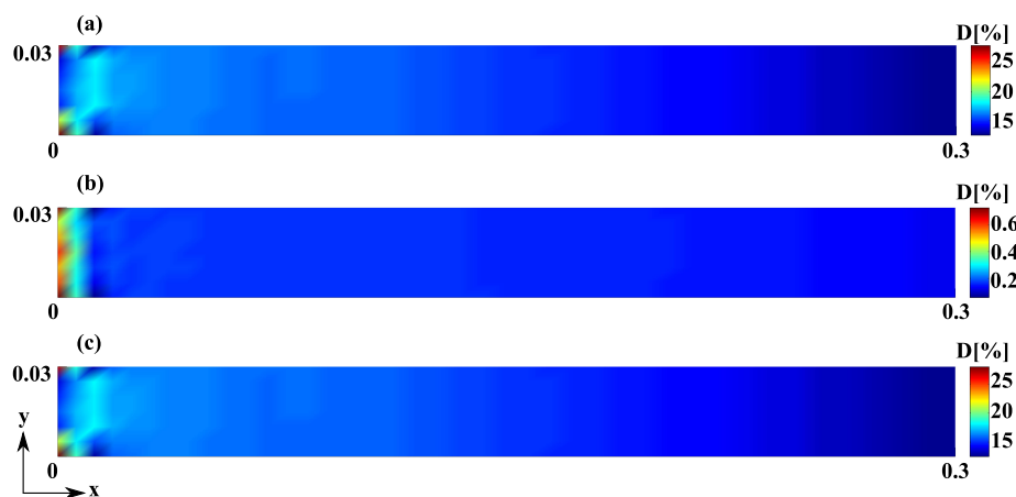
FIGURE 3.18 – États de l'endommagement obtenus par le méta-modèle appliqué à la poutre (90^\circ/0^\circ/90^\circ) avec F = 1.2 \cdot 10^5 N/m , (a), (b) and (c) sont respectivement les couches supérieure, centrale et inférieure
