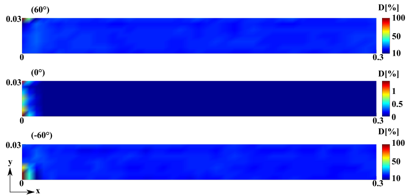
FIGURE 3.22 – États de l'endommagement obtenus par le méta-modèle appliqué à la poutre ( 60^\circ/0^\circ/-60^\circ )
