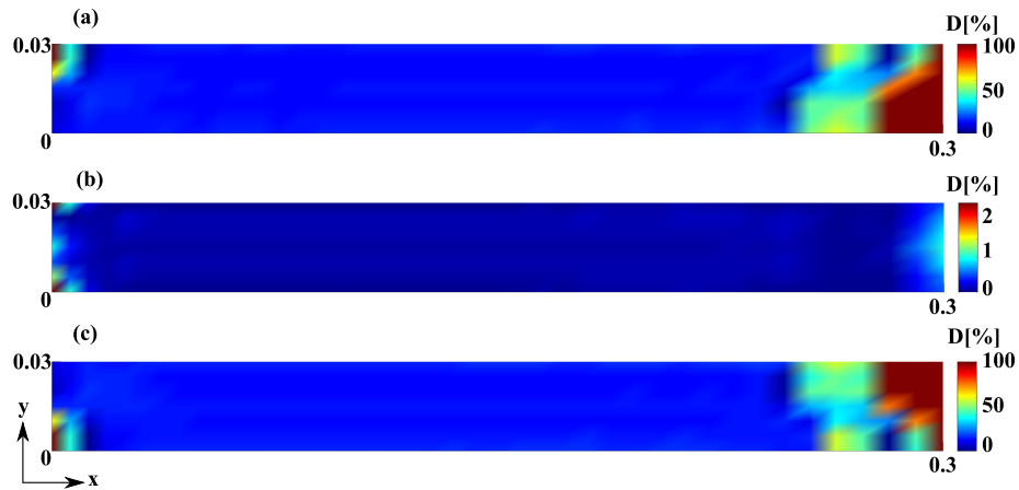
FIGURE 3.14 – État de l'endommagement par couche de la poutre ( 45^\circ/0^\circ/ - 45^\circ ) avec F_0 = 2.28 \cdot 10^5 \text{ N/m} , (a), (b) and (c) sont respectivement les couches supérieure, centrale et inférieure
