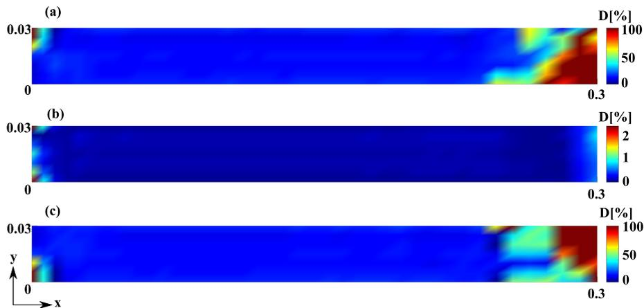
FIGURE 3.19 – États de l'endommagement obtenus par le méta-modèle appliqué à la poutre ( $45^\circ/0^\circ/ - 45^\circ$ ) avec  $F = 2.28 \cdot 10^5 N/m$ , (a), (b) and (c) sont respectivement les couches supérieure, centrale et inférieure
