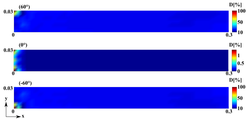
FIGURE 3.21 – États de l'endommagement obtenus par le modèle complet appliqué à la poutre ( 60^\circ/0^\circ/-60^\circ )
