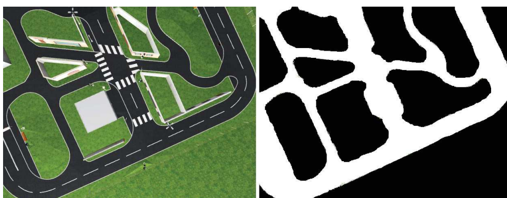
Figure 4.10. – Image aérienne provenant du simulateur et résultat de segmentation couleur de l'espace navigable.
