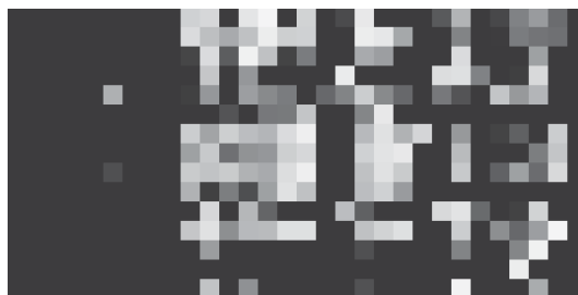
Figure 3.2. – Représentation du problème sous forme de carte de coûts. La matrice de coûts C est représentée sous la forme d’une grille où l’intensité dépend de la similitude entre les nœuds. Les lignes sont les nœuds de la carte terrestre et les colonnes sont les nœuds de la carte aérienne.
