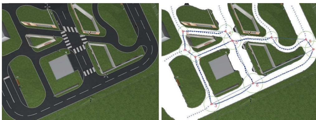
Figure 2.14. – Segmentation et cartographie de l'image aérienne. (gauche) Image obtenue dans le simulateur 4Dvirtualiz sur le site Pavin. (droite) L'espace navigable extrait est en blanc et la carte hybride est superposée.
