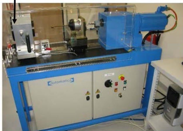
FIGURE 4.21: Banc d'essais couple-tension
