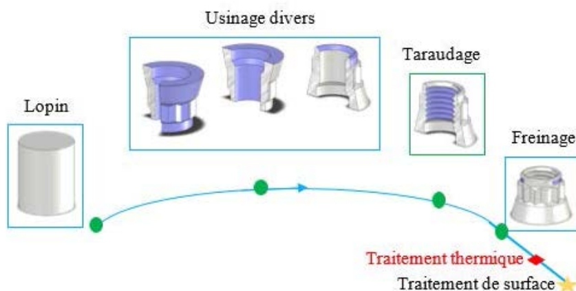
FIGURE 4.13: Gamme de fabrication des écrous [AER ]
