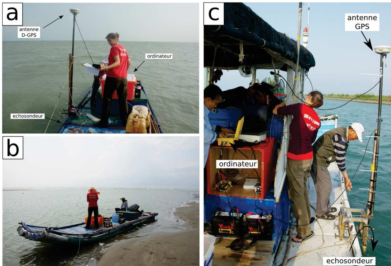
FIGURE 3.6 – Photographies de terrain pour les levés bathymétriques. a) Bathymétrie réalisée avec le D-GPS (précision centimétrique, levés du 28 juin, 18 et 30 juillet 2012) et le b) bateau de pêcheur. c) Bathymétrie réalisée avec l'équipe du laboratoire de THL et un GPS métrique (levé du 5 mai).
