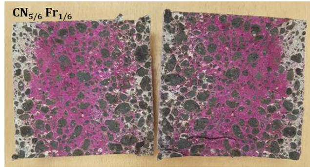
**Figure 7.8.** Illustration du front de carbonatation par pulvérisation de phénolphtaléine de quelques BISAP-Lc
