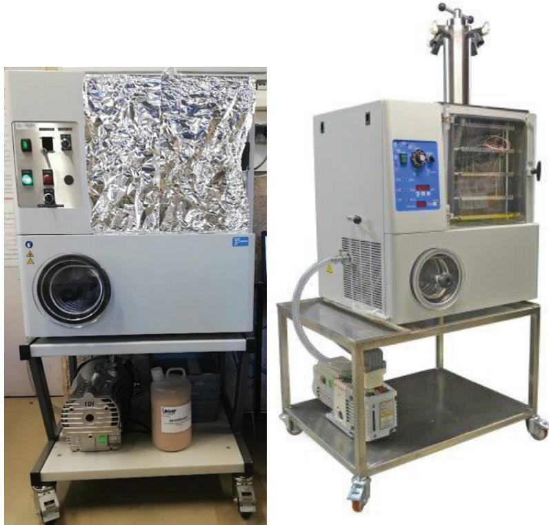
*Figure 232 : Lyophilisateur pilote de paille Cryotec*
