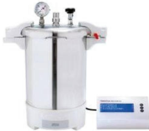
Figure 20 : Stérilisateur autoclave Certoclav Multicontrol 2 utilisé pour la stérilisation des liquides et du matériel de culture
