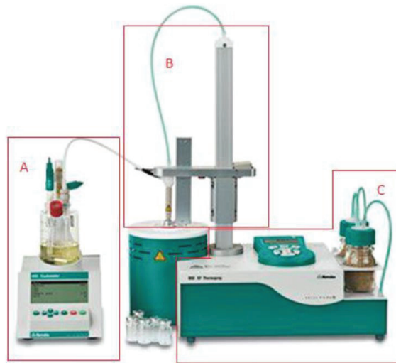
Figure 298 : Coulomètre Karl Fischer Thermoprep utilisé pour la mesure d'humidité résiduelle des lyophilisats
