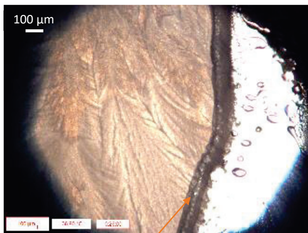
-iii) Elargissement du collapse ( -26,50^{\circ}\text{C} )
