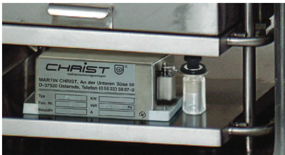
Figure 75 : Photo de la microbalance Christ MTC-ZER pour mesure in situ des cinétiques de sublimation
