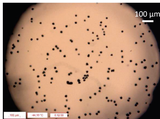
Figure 398 : Echantillon à 50% (m/m) de PVP durant la remontée en température avec apparition des premiers nucléi à -44,1°C
