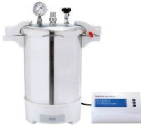
Figure 20 : Stérilisateur autoclave Certoclav Multicontrol 2 utilisé pour la stérilisation des liquides et du matériel de culture
