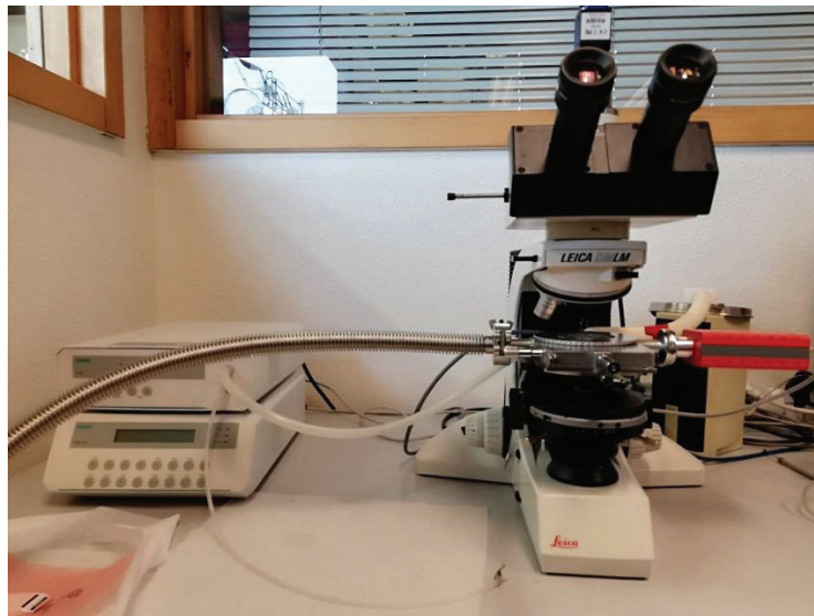
Figure 276 : Montage utilisé pour la détermination des températures de collapse : microscope à platine réfrigérée avec régulation de la température
