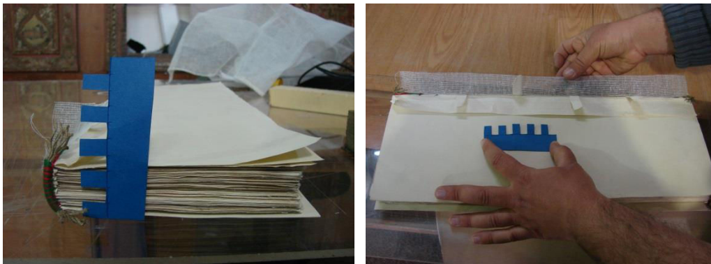
Image 40 la tranchefile et la pose de la mousseline
