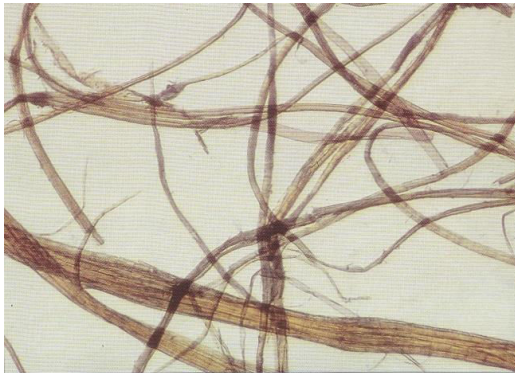
IMAGE 22 coloration jaune brun de HERZBERG Fibres non fibrillées
