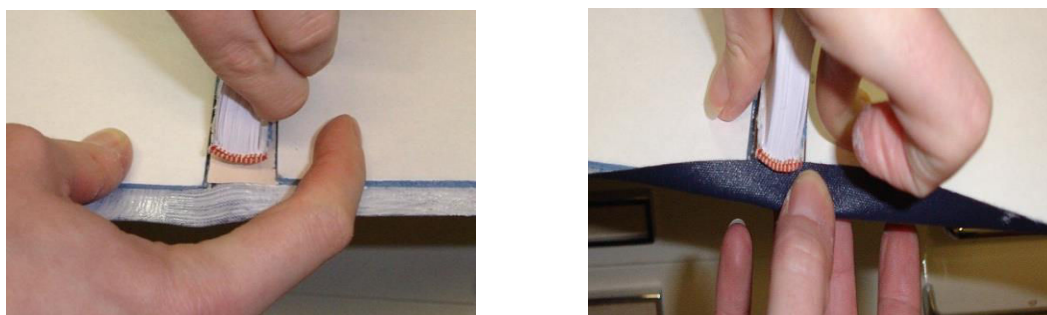
Image 35 pliage de la toile entre le faux dos et le registre
