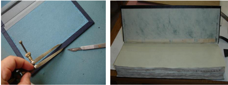
Image 37 la coupe des remplis et la colle de la page de garde
