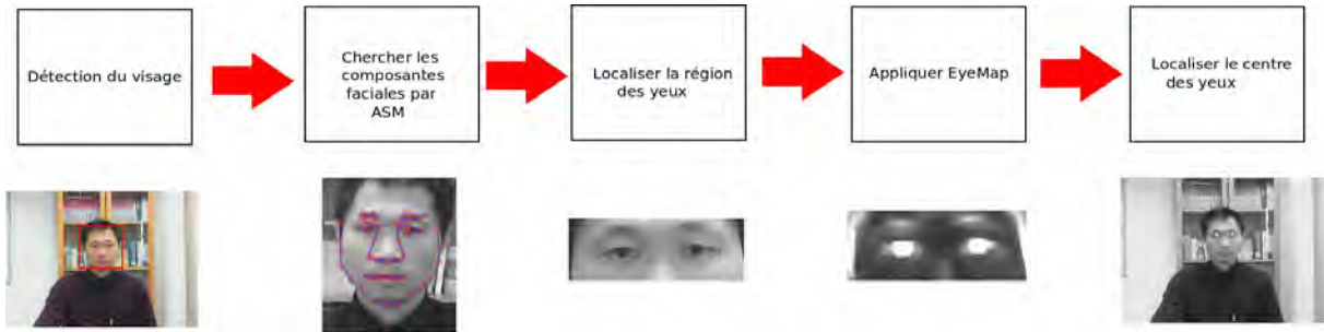
FIGURE 3.12 – Le schéma de la localisation des yeux
