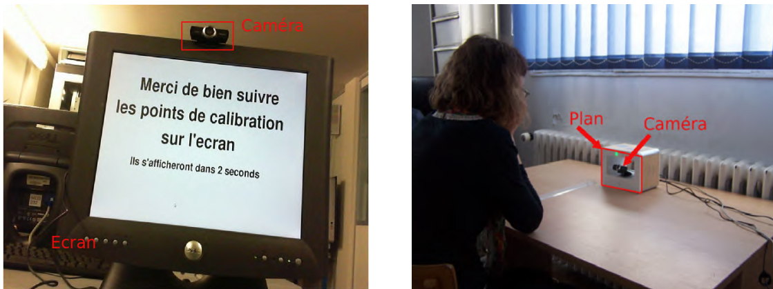
FIGURE 2.22 – L'environnement de l'expérimentation. Gauche : l'installation de la webcam et l'écran. Droite : la position de la webcam et le plan où le sujet doit regarder.
