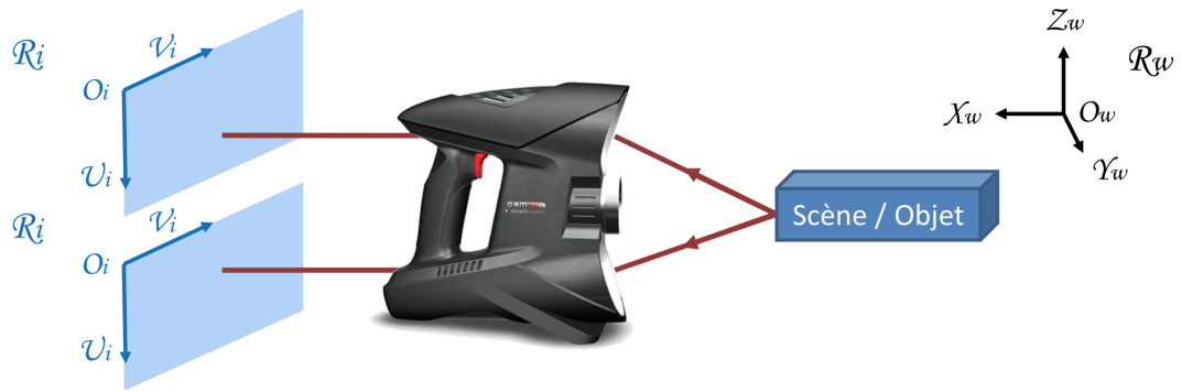
FIGURE 7 – Exemple d’un système de stéréovision. Image tirée de [PEYROT, 2014].
