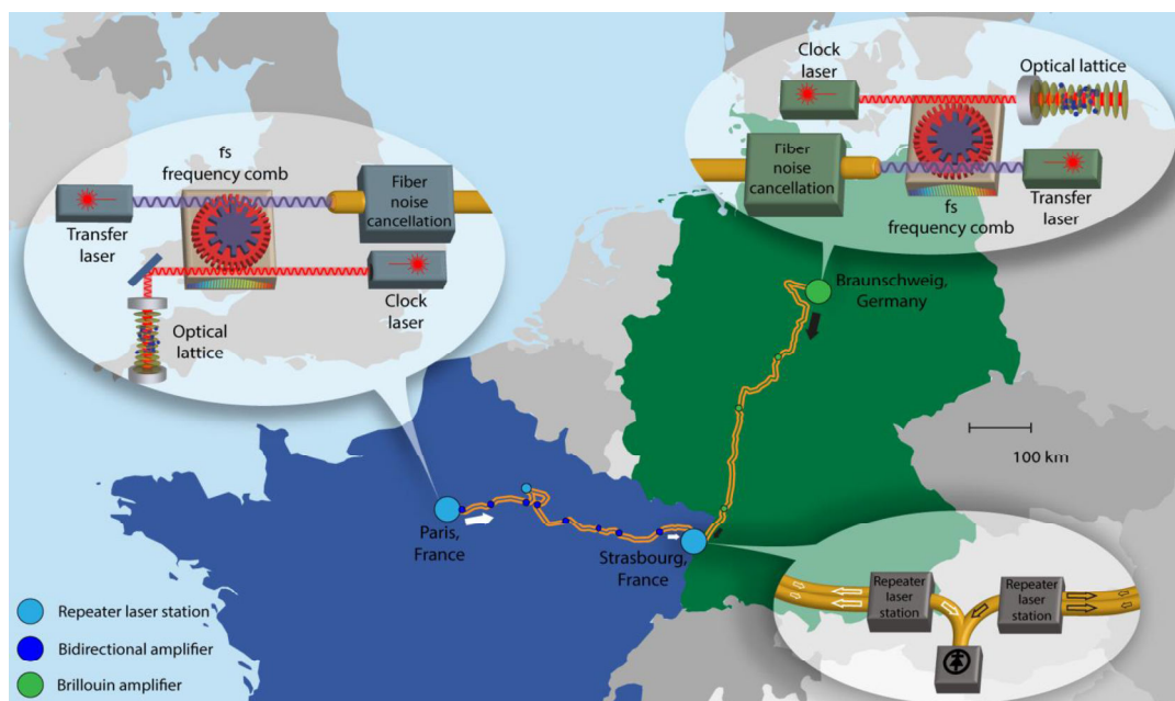
FIGURE 1.9 – Grand lien européen de 1415 km entre le SYRTE à Paris et le PTB à Braunschweig. En France, le canal dédié est constitué de 4 liens cascades avec des EDFA bidirectionnels et 5 stations Régénératrices dont 1 à Strasbourg. En Allemagne, la fibre dédiée est réalisée avec des amplificateurs Brillouin, des EDFA et 1 station Régénératrice à Strasbourg. Les sorties locales des deux stations à Strasbourg permettent de comparer les deux horloges strontium distantes.
