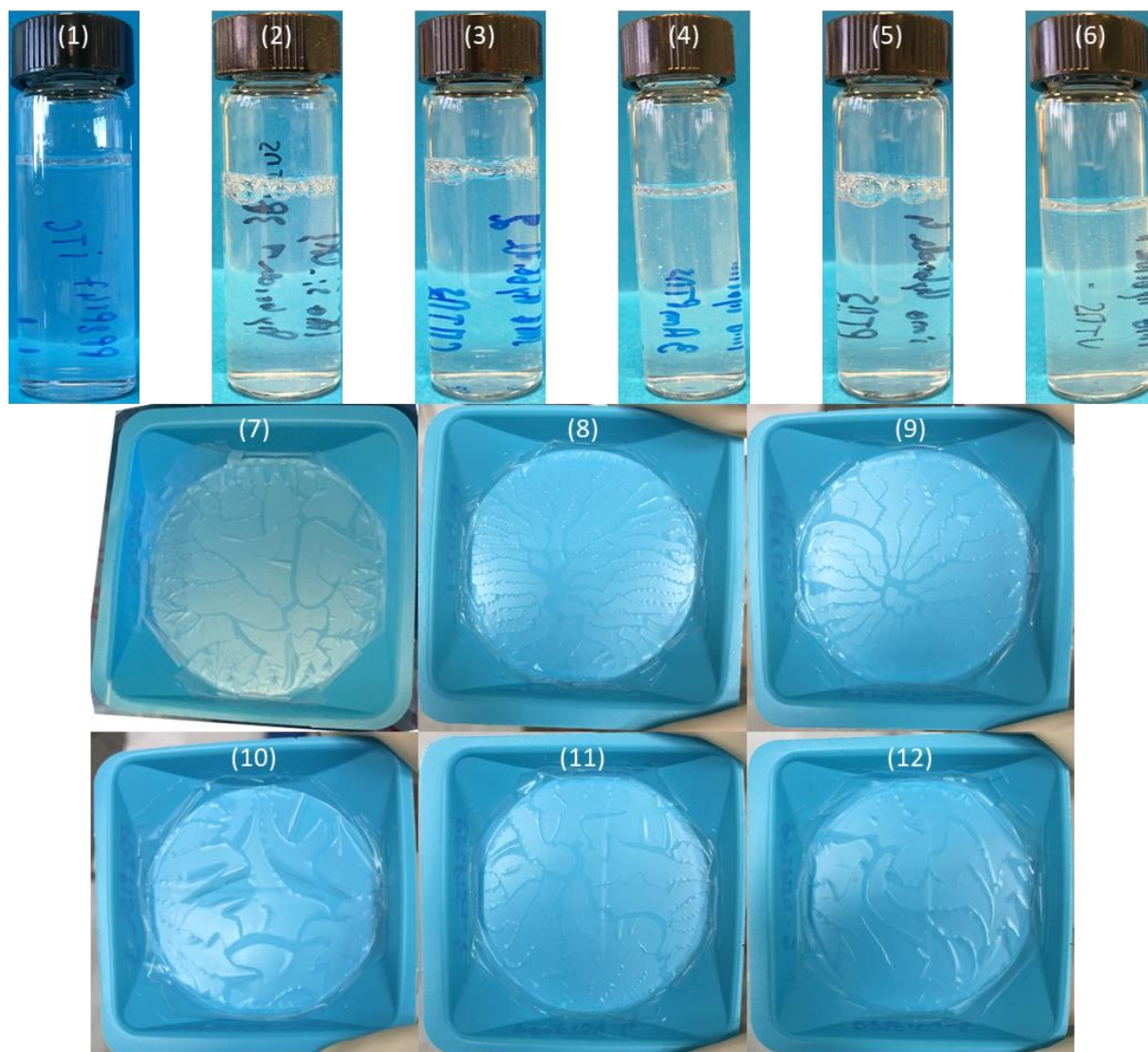
Figure 5.1 – Photos en phase liquide après dialyse et avoir été laissées sécher une nuit à 70°C des dispersions d'imogolite-méthylée (1/7), d'imogolite-bromo (2/8), d'imogolite-chloro (3/9), d'imogolite-amino (4/10), d'imogolite-propyl (5/11) et d'imogolite-vinyl (6/12) avec une substitution initiale de 5 %. Les piluliers ont été agité avant de prendre les images.
