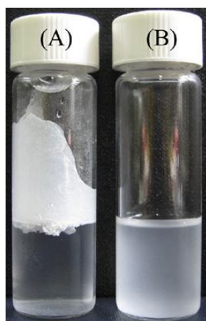
Figure 2.12 - Imogolite d'aluminogermanate modifiée par de l'AODP dispersée dans de l'eau (A) et dans du chloroforme (B). 43
