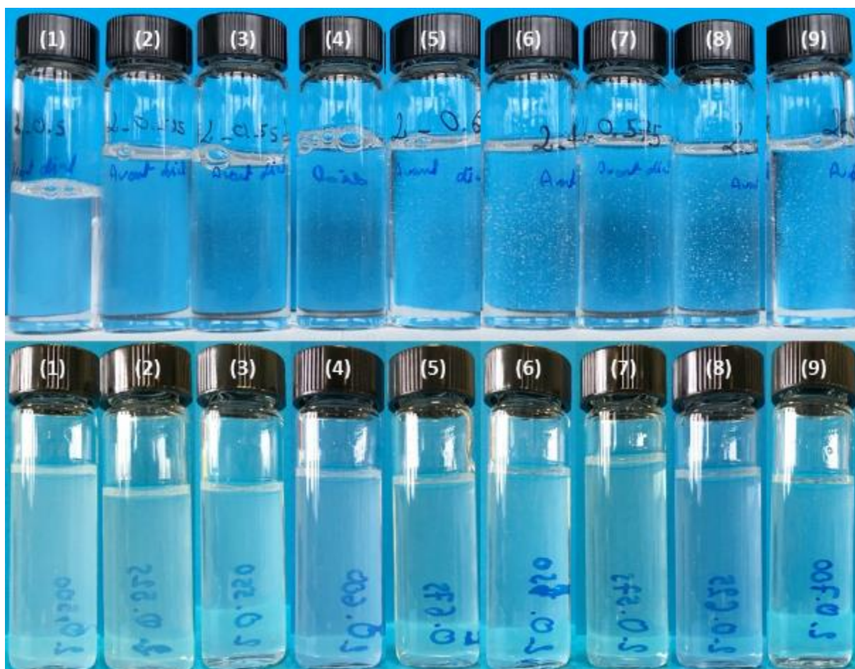
Figure 4.1 – Photos des 9 dispersions. De gauche à droite le ratio Si/Al augmente. La ligne du haut correspond aux échantillons avant la dialyse et la ligne du bas après la dialyse. Avant de prendre les photos, les piluliers ont été agités.
