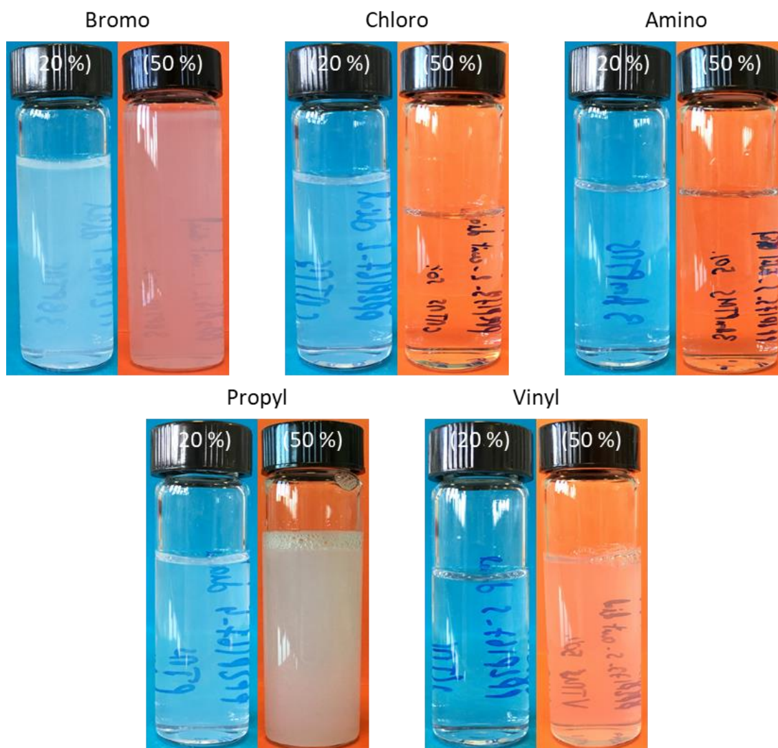
Figure 5.5 – Photos des dispersions d'imogolite-bromo (en haut à gauche), d'imogolite-chloro (en haut au milieu), d'imogolite-amino (en haut à droite) d'imogolite-propyl (en bas à gauche) et d'imogolite-vinyl à 20 % (fond bleu) et 50 % (fond orange) de substitution du TMMS.
