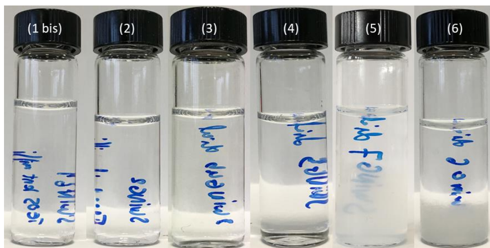
Figure 3.40 – Photos des cinétiques après l'étape de croissance et après dialyse. Le nombre entre parenthèses correspond au numéro de la cinétique.
