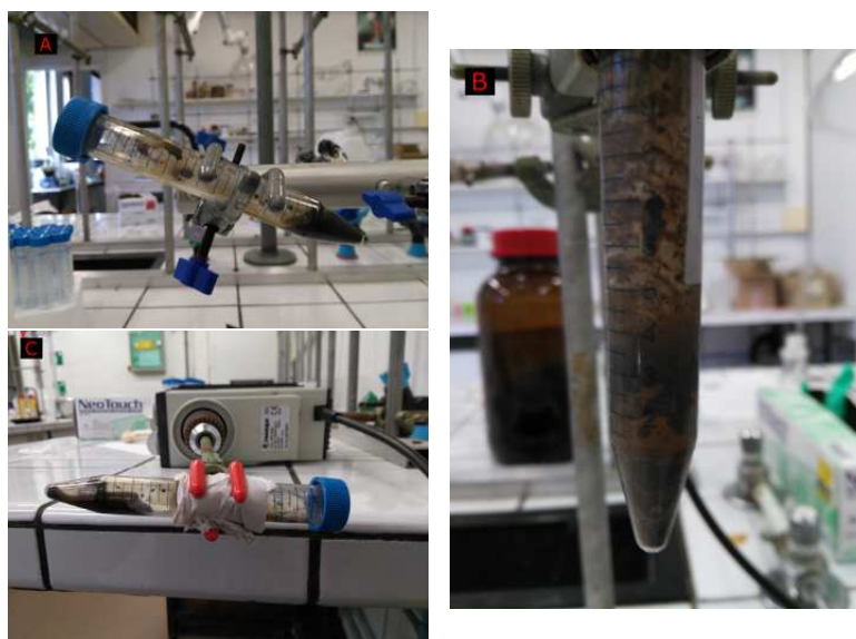
Figure 4.8 – A : Agitation par un bras vibrant. B : inhibition de la réaction à cause d'une mauvaise agitation. C : Agitation mécanique.
