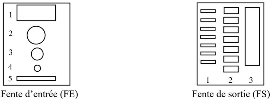
**Figure A1.8** Fentes disponibles à l'entrée et à la sortie de l'analyseur HSA EA125.
