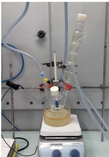
Figure 62 : Montage expérimental pour la réaction de silanisation
