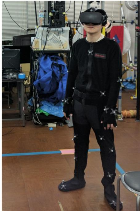
FIGURE 5.3 – Un participant avec le visiocasque et la combinaison de capture de mouvement. Le tabouret (également suivi par notre système) est visible en bas à droite de l'image.
