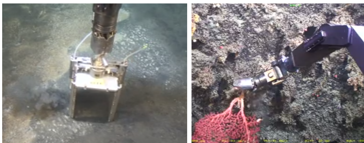
(a) Carottage en utilisant un outil dédié.
