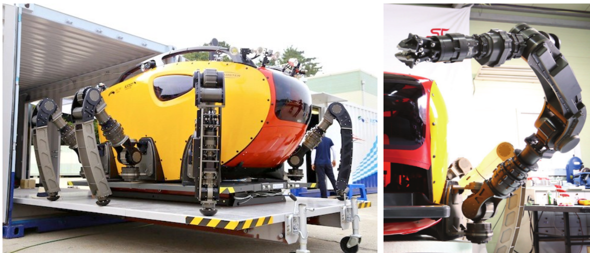
(a) Crabster équipé de ses six jambes. Les deux jambes avant se transforment en bras. (crédit : KIOST)
