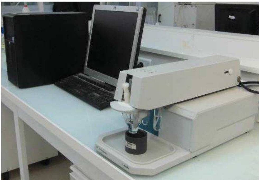
Figure 4.4 : Voltampéromètre relié à un ordinateur de contrôle.
