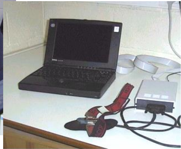
Figure 1.2 Dispositif DADOM développé par l'équipe OMA pour le suivi de l'oxygénation musculaire par spectroscopie infrarouge (10). Deux diodes lasers illuminent le tissu à deux longueurs d'onde différentes dans l'infrarouge proche, et l'étude de la lumière rétrodiffusée à trois distances des sources permet de remonter à l'oxygénation du muscle.
