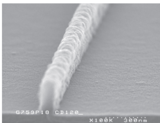
FIGURE 3.4 – Vue en coupe d'une ligne de résine
