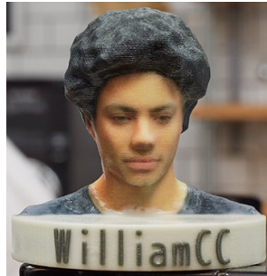
FIGURE 3 – Modèle 3D d'un visage scanné par un téléphone portable par prise de photos successives sous différents angles
