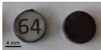
Figure II - 50 : Photographies de verres SPS ayant subi un préfrittage (gauche) et sans préfrittage (droite) (épaisseur = 1,7 mm).
