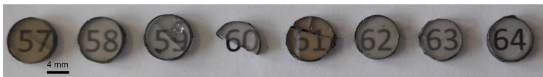
Figure II - 56 : Photographies de verres obtenus avec un cycle SPS où l'arrêt de la température se fait manuellement après observation du frittage. Les températures de frittage varient entre 365°C et 390°C.
