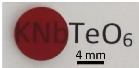
Figure IV - 71 : Photographie d'une céramique non dopée élaborée par SPS à 550°C pendant 20 min sous 100 MPa.
