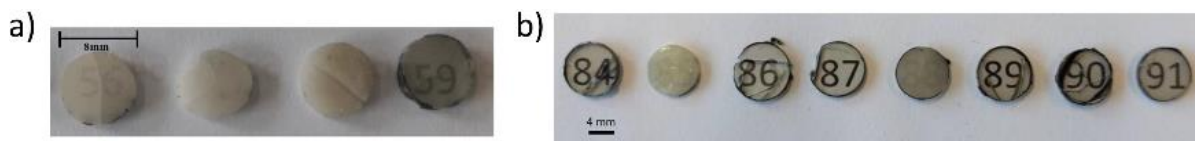
Figure II - 54 : Photographies des verres (épaisseur = 1,7 mm) SPS réalisés à une température maximum de a) 365°C et b) 385°C.
