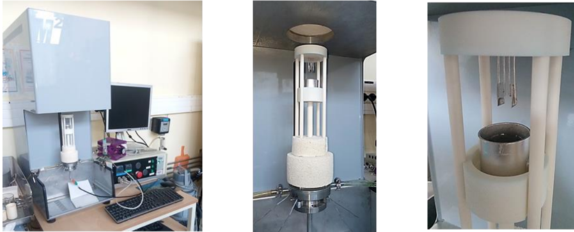
Figure III-7. Présentation du montage 4 électrodes utilisé au LDMC pour la mesure de conductivité de fonte verrière.
