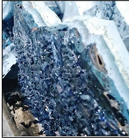
Figure III-2. Photographie d'un morceau de reliquat d'un verre vitrocristallin avec vue sur la strate 1 de fritte infondue [10].
