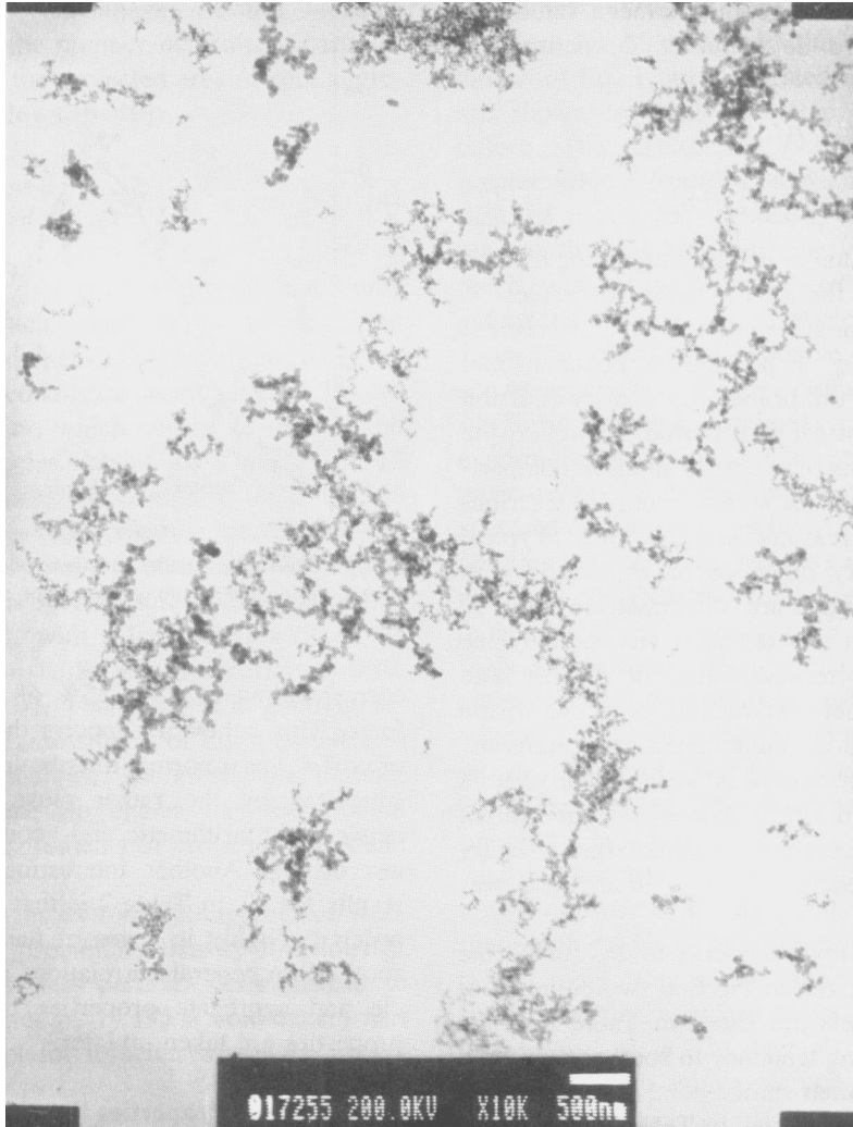
Figure 1.5: Photographie obtenue par TEM (Transmission Electron Microscopy) d'agrégats de suie collectés dans une flamme de diffusion turbulente acétylène/air (photo issue de [97]).
