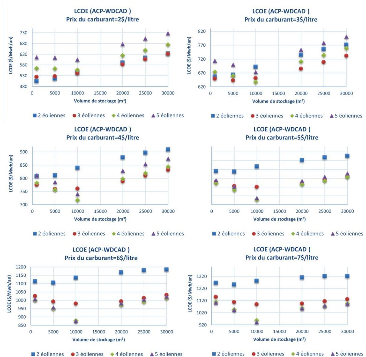
Figure 102- LCOE pour différentes configurations et différents prix de carburant
