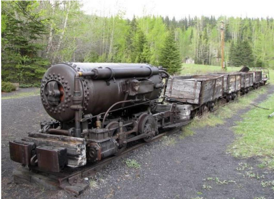
*Figure 12 - Une locomotive à air comprimé utilisée pour transporter le charbon et les mineurs dans la mine de charbon de Bankhead (Alberta, Canada) au début du XXe siècle entre 1904 et 1922 (Source : [https://en.wikipedia.org/wiki/Bankhead,\\_Alberta](https://en.wikipedia.org/wiki/Bankhead,_Alberta))*
