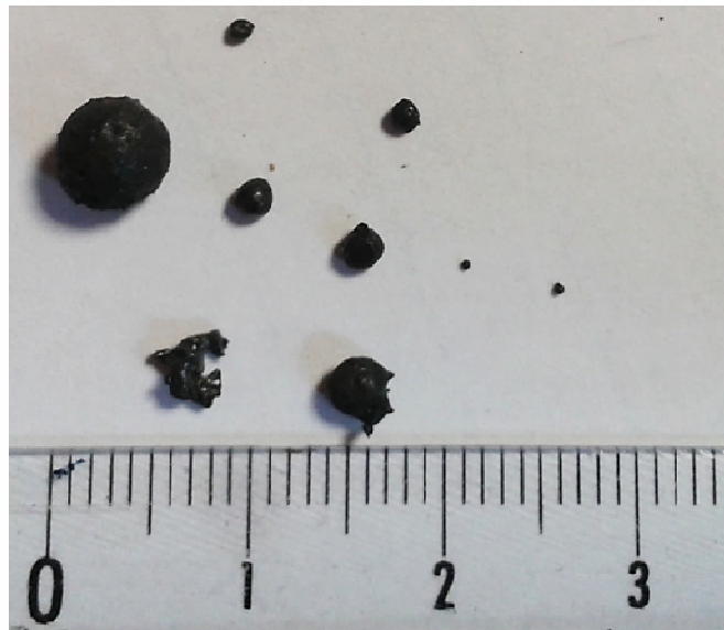
Figure 45 : Billes retrouvées dans le charbon issu du mélange C – unité en cm
