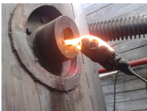
Figure 22 : Allumage du réacteur industriel
