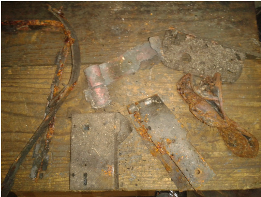
Figure 31 : Morceaux métalliques retrouvés dans le réacteur après des tests au CSR Bois
