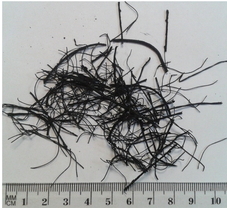
Figure 44 : Fils métalliques retrouvés dans le charbon du Mélange A
