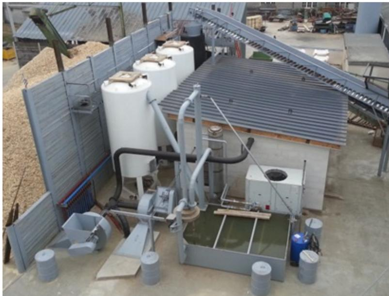
Figure 19 : Photographie d'ensemble de l'unité de cogénération par gazéification d'Enerxyl
