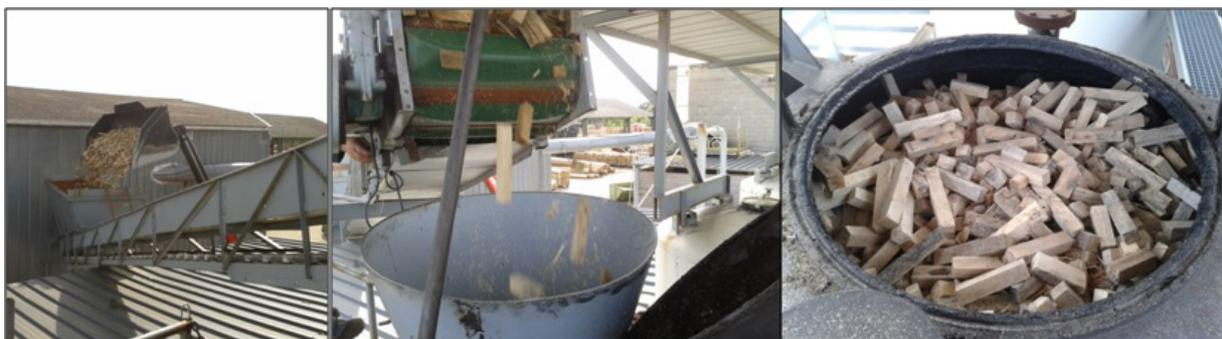
Figure 21 : Chargement du réacteur industriel (ici peuplier)
