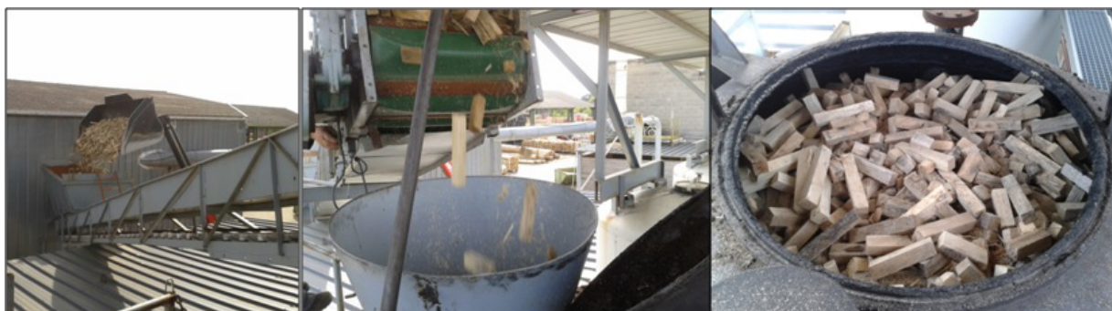
Figure 21 : Chargement du réacteur industriel (ici peuplier)
