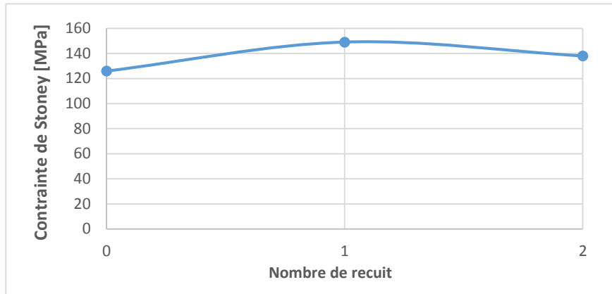
Figure 3-21 : Contraintes de Stoney après dépôt, après un premier et après un deuxième recuit – Moyenne sur 4 échantillons
