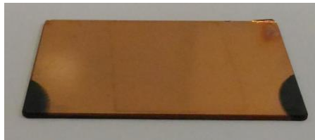
Figure 1-3 : Couche mince de cuivre (de 5\mu\text{m} d'épaisseur) sur un substrat de YIG de 1000\mu\text{m} d'épaisseur et de 5cm de long et 2,5cm de large
