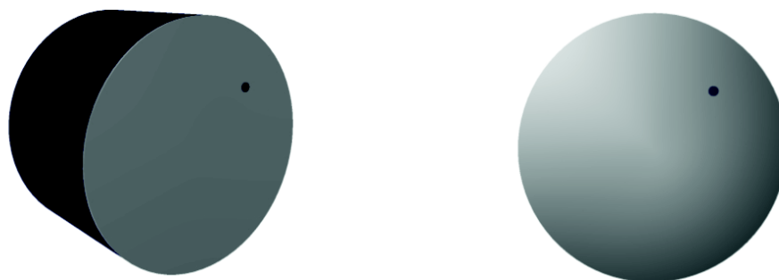
FIGURE II.20 – En noir, le moniteur. En gris, le collimateur en aluminium. L'ouverture du collimateur (petit cercle noir sur la vue de face, à droite) est située sur le pourtour du détecteur afin de pouvoir changer de zone d'irradiation par rotation du moniteur lorsque celui-ci est endommagé.
