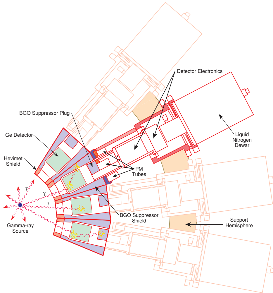
FIGURE II.3 – Schéma en coupe d'une partie de Gammasphere [80, 81].
