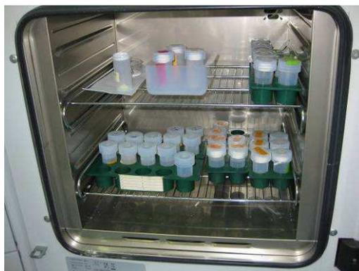
**Figure 31.** Photographie de réacteurs de dissolution et d'une étuve utilisés pour les tests de dissolution réalisés en mode statique (HNO<sub>3</sub> 2 M, T=90°C).
