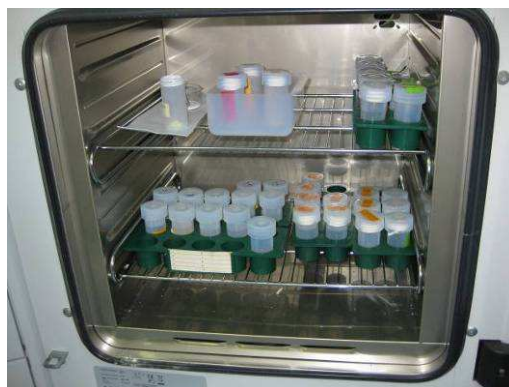
Figure 31. Photographie de réacteurs de dissolution et d'une étuve utilisés pour les tests de dissolution réalisés en mode statique (HNO 3 2 M, T=90°C).
