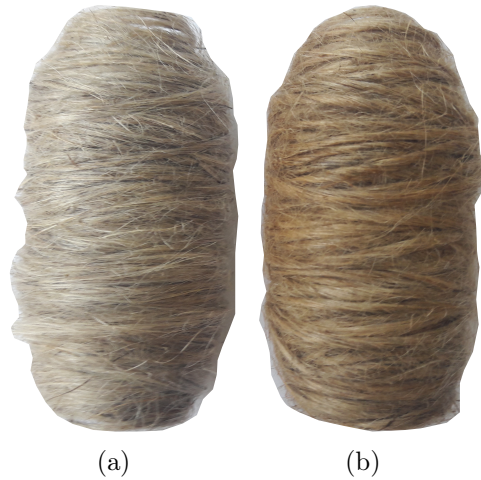
FIGURE 2.13 – Photos des lots de fibres de chanvre. (a)Fibres non traitées. (b)Fibres traitées au \text{CO}_2 sc.
