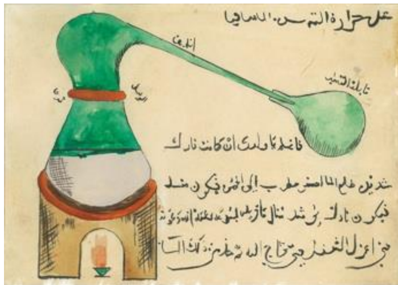
Alambic inventé par Jabir Ibn Hayyan (Geber), 721-815. On lui attribue la découverte des acides chlorhydrique, nitrique, acétique ainsi que l'eau régale.
