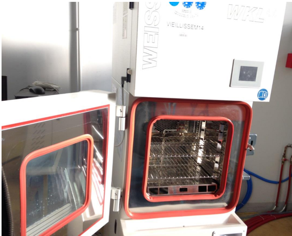
Figure 9.1.1 : Enceinte climatique Weiss WKL 34/+10 pour le vieillissement cyclique hygrothermique
