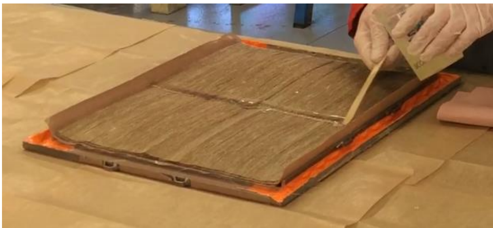
Figure 5.3.7.1 : Imprégnation manuelle d'un pli de résine dans le moule
