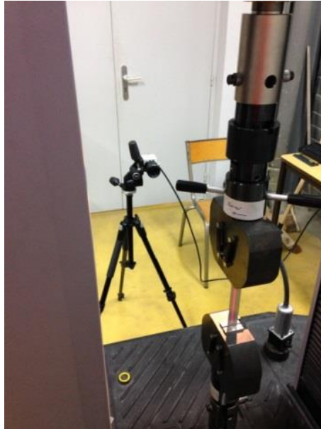
Figure 4.2.2.2.1 : Presse MTS et dispositif de corrélation d'images
