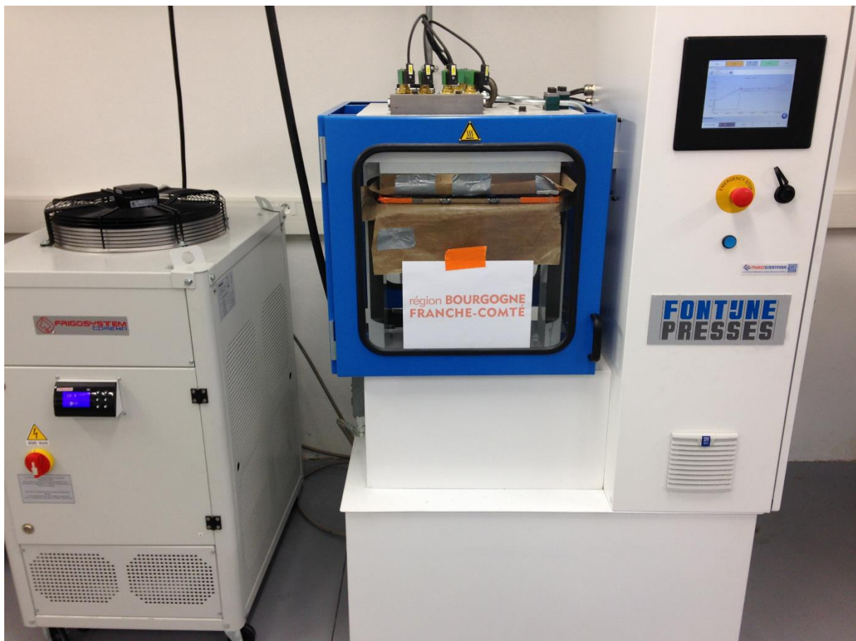
Figure 5.2 : Presse de thermocompression Fontijne Grotnes TPC 321 avec groupe de refroidissement sur la gauche
