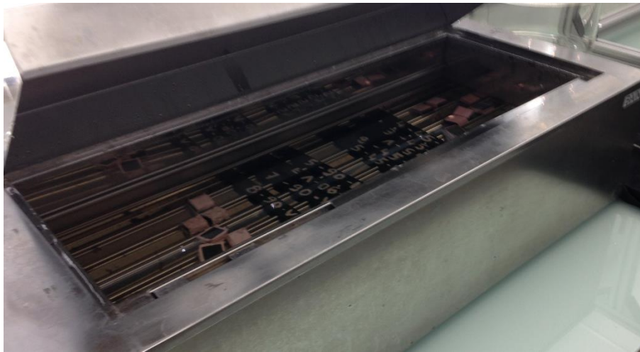
Figure 6.2 : bain statique pour l'immersion à 70 °C
