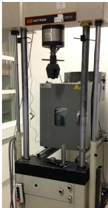
Figure 4.2.4.1 : Presse hydraulique Instron 8501 équipée d'un capteur de force de 100 kN
