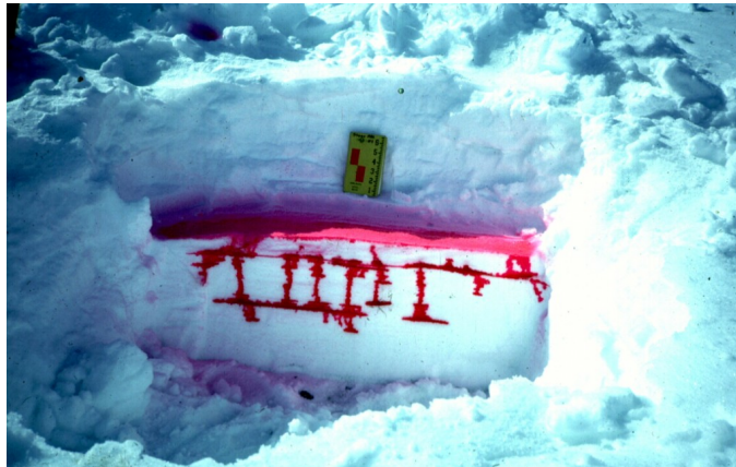
FIGURE F-VIII.1 Exemple d'écoulements préférentiels pouvant avoir lieu dans la neige (source : http://philipmarsh.ca ).
