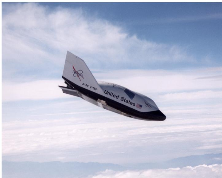
FIGURE 2 – X-38, véhicule de retour d'urgence d'équipage [2]
