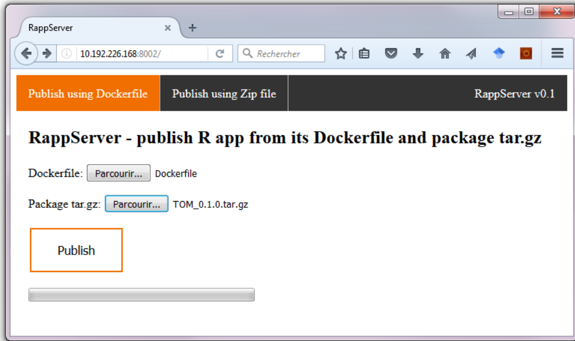
FIGURE 7.5 – Déploiement à partir d'un Dockerfile via l'interface graphique
