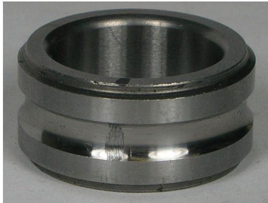
FIGURE 4.2 – Défaut de bague interne.
