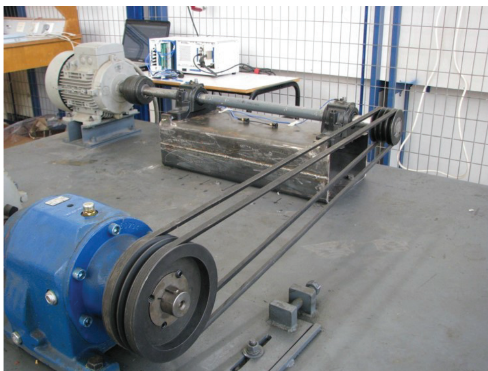
FIGURE 4.8 – Banc expérimental de roulement.
