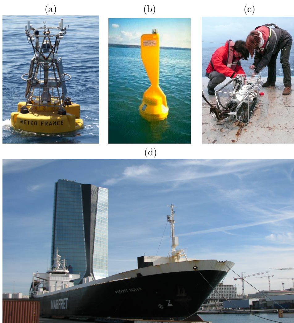
FIGURE 6 – Photographies (a) de la bouée ancrée au large de Nice, (b) d’une bouée dérivante de type Marisonde, (c) de la sonde CTD à bord du Provence lors de la POI16a (crédits photo : S. Belamari, Météo-France) et (d) du système SEOS à bord du Marfret-Niolon (crédits photo : D. Legain, Météo-France).
