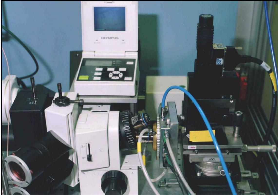
**Figure 7.1** Mise en place de la platine chauffante permettant de réaliser des mesures photothermiques sous atmosphère contrôlée et à température élevée (i.e. jusqu'à 1500°C).
