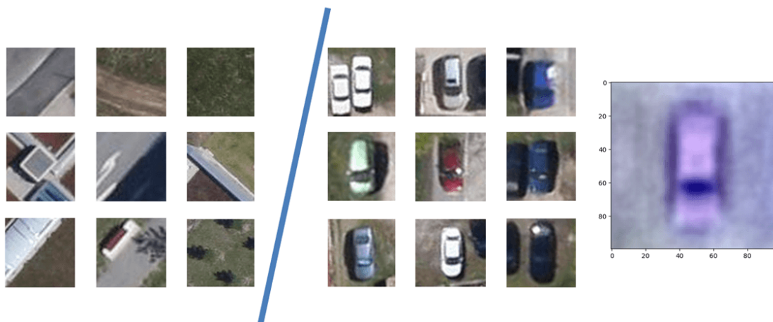
FIGURE 2.1 – De gauche à droite : des exemples de fonds de la base Munich, des exemples de voitures et les poids d'un SVM linéaire entraîné en classification (réorganisés spatialement et normalisés)
